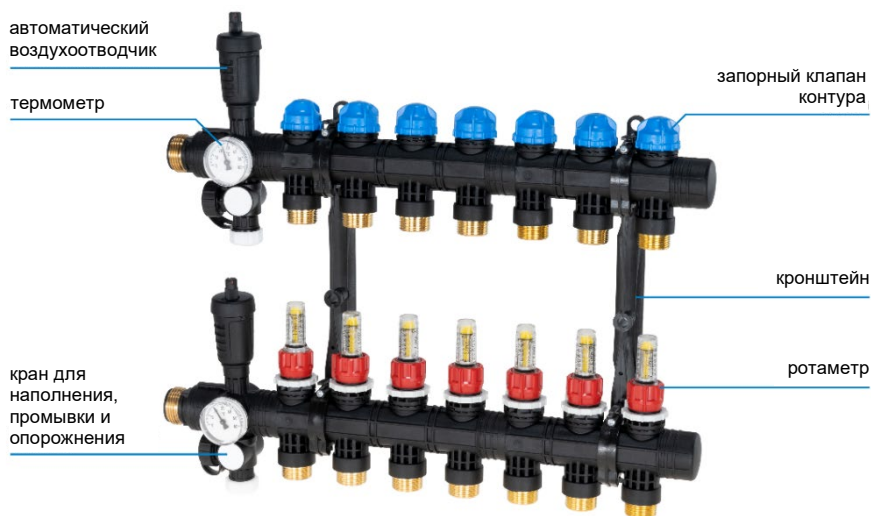
Рисунок 2: Конструкция коллектора ProCalida EF1
