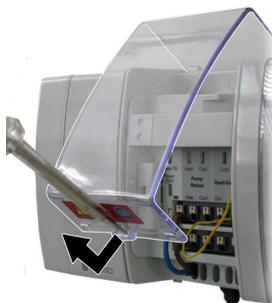
1. Откройте крышку с помощью отвертки.
