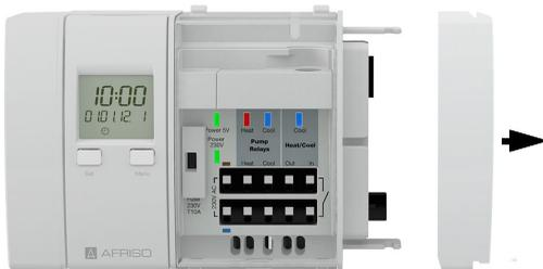
2. Снимите торцевую крышку.
