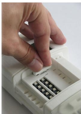
4. Вставьте держатель предохранителя в отсек для предохранителей.
