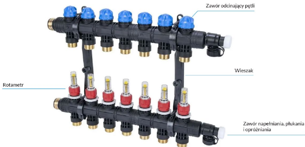
Rysunek 1: Budowa rozdzielacza ProCalida EF1 K
